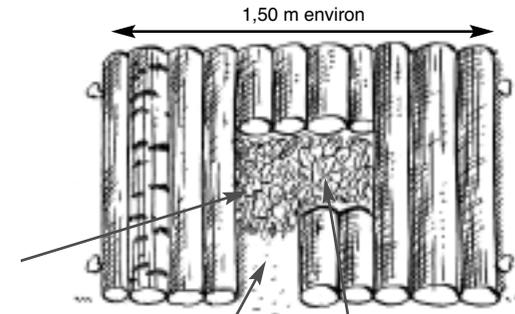
La chambre mesure environ 30 cm de long sur 20 à 25 de large. Prévoyez une hauteur d'environ 20 cm.
